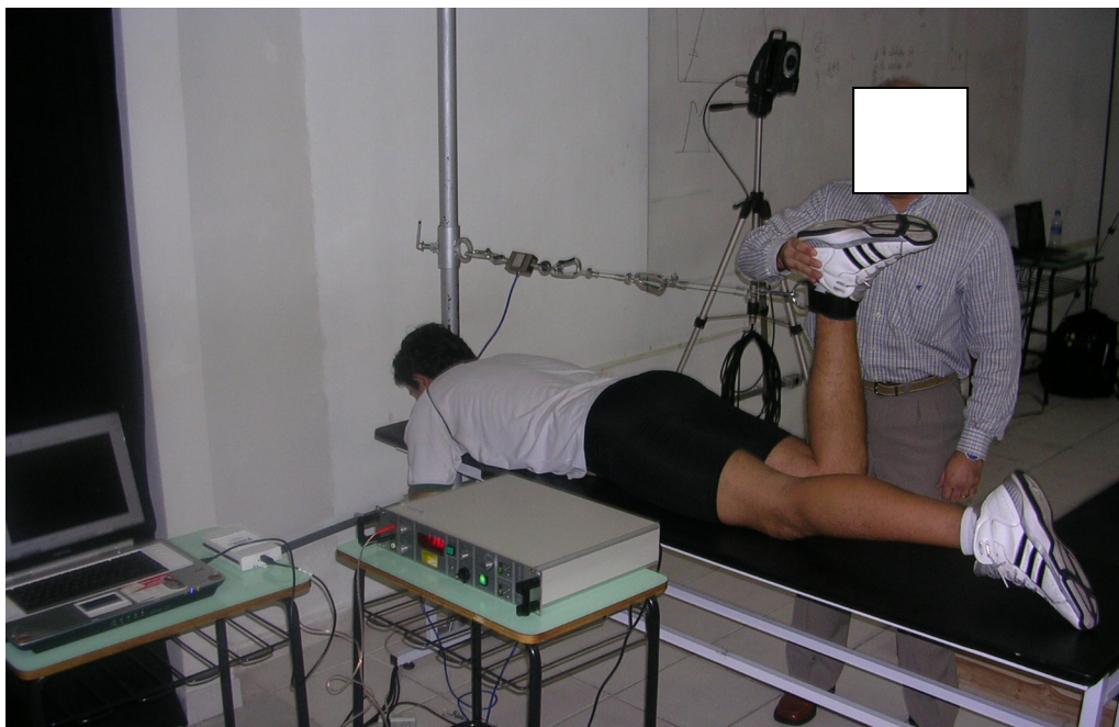
FIGURA 05 – Teste de força e taxa de desenvolvimento de torque dos extensores do joelho.
