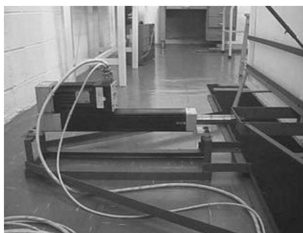
**Figura 2:** Servo-motor e cilindro de um eixo acoplados à estrutura metálica da sala móvel.
