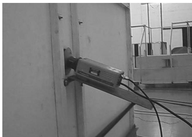
**Figura 4:** Vista externa da sala móvel mostrando a parede do fundo da sala com o suporte e a câmera de vídeo utilizada.
