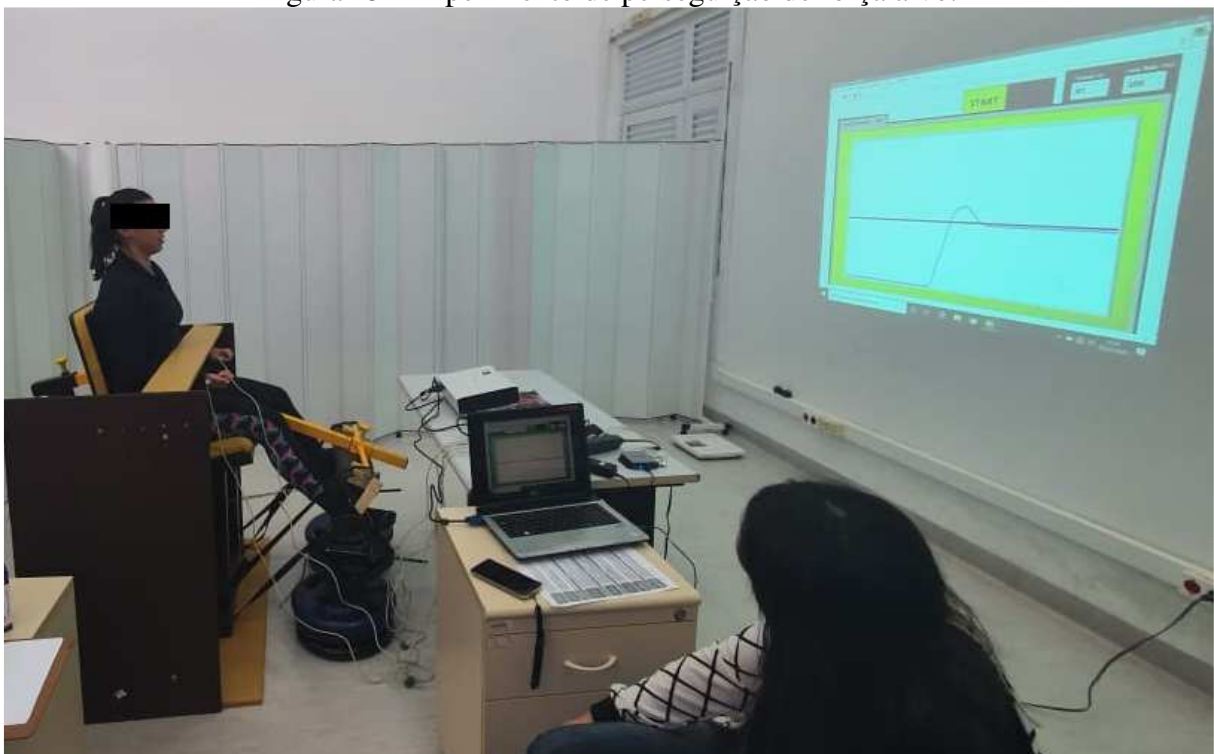
Figura 23 - Experimento de perseguição de força alvo.
