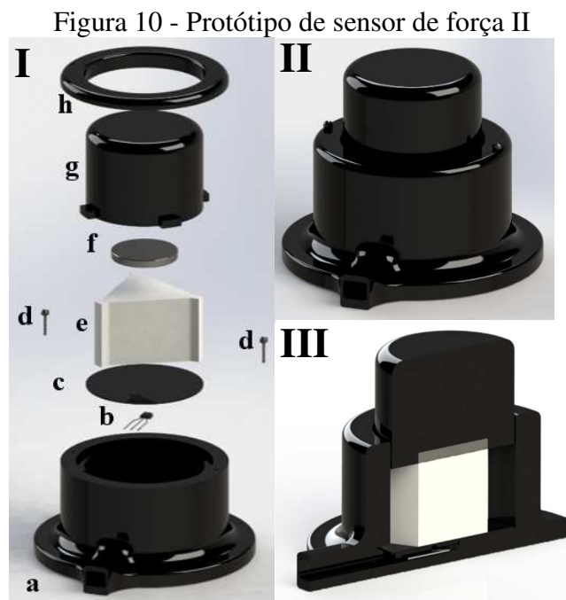
(I) Vista explodia; a – base; b – sensor de efeito Hall; c- disco de separação; d – parafusos de fixação; e – elastômero; f – ímã; g – ponta de prova; h – tampa fim de curso. (II) Montado. (III) Vista de corte.
