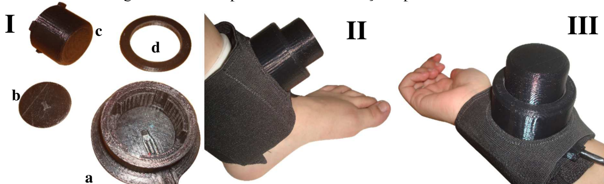
Figura 12 - Protótipo II de sensor de força impresso em ABS. (I) Desmontado; a – base; b – disco de separação; c – ponta de prova; d – tampa fim de curso; e - caneleira. (II) Montado e fixado no tornozelo. (III) Montado e fixado no punho.
